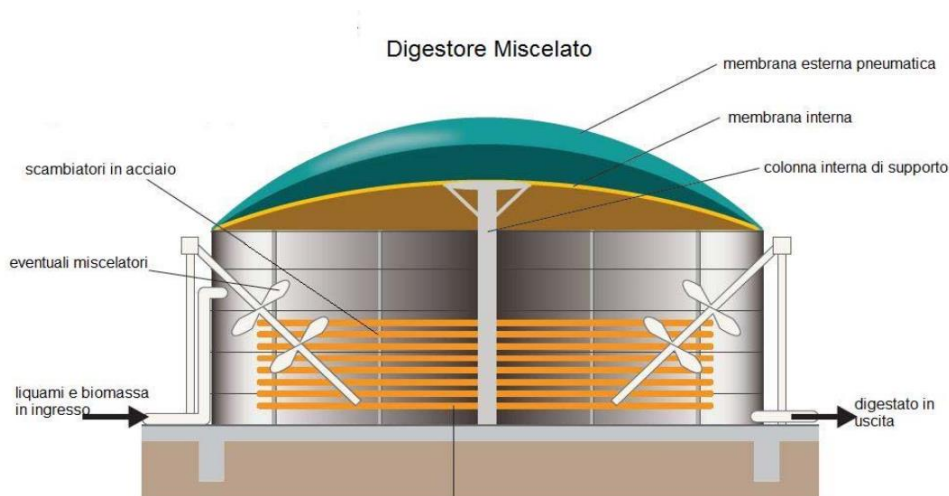
Figura 8 Esempio di reattore CSTR
