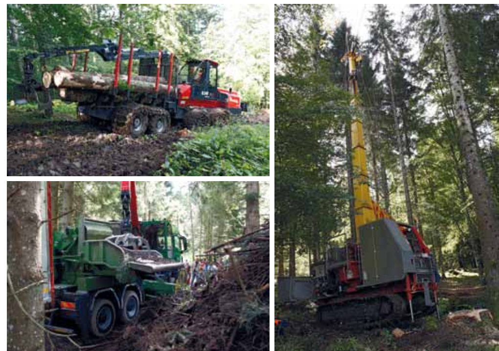
Figura 32: Forwarder "Brutale" Bernardi (in alto a sinistra), camion cippatore "Hacker-Truck PTH1200/820" Pezzolato (in basso a sinistra) e teleferica "V600/1000/B10" Valentini (a destra) durante la dimostrazione tenutasi a Farra d'Alpago.
