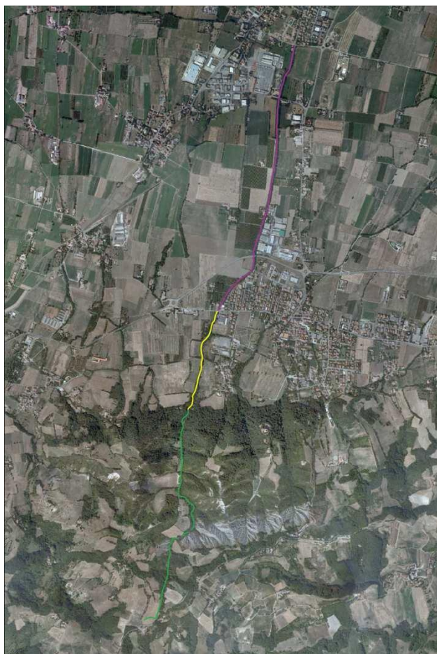
Figura 14 – Morfologie fluviali presenti nel Rio Enzola: confinato a canale singolo (verde); sinuoso (giallo); rettilineo (viola)
