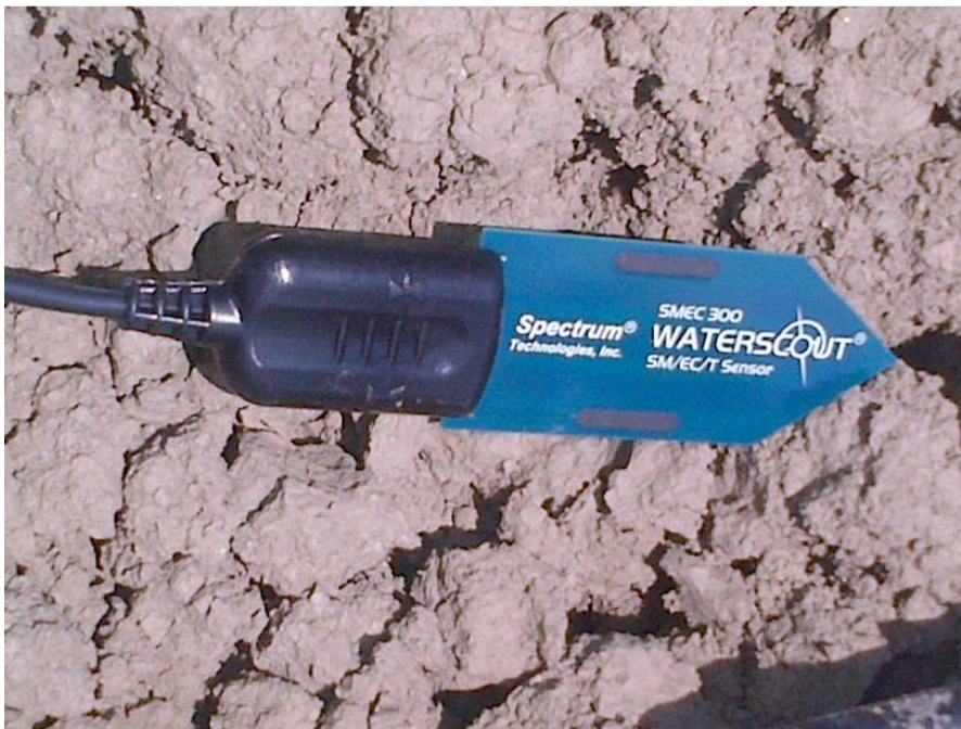
Figura 12. Sensore per la misura dell'umidità del suolo e della conducibilità delle acque interstiziali.
