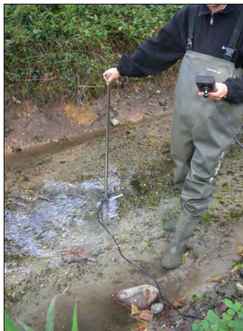
Fig. 14 – Misura con correntometro Doppler
