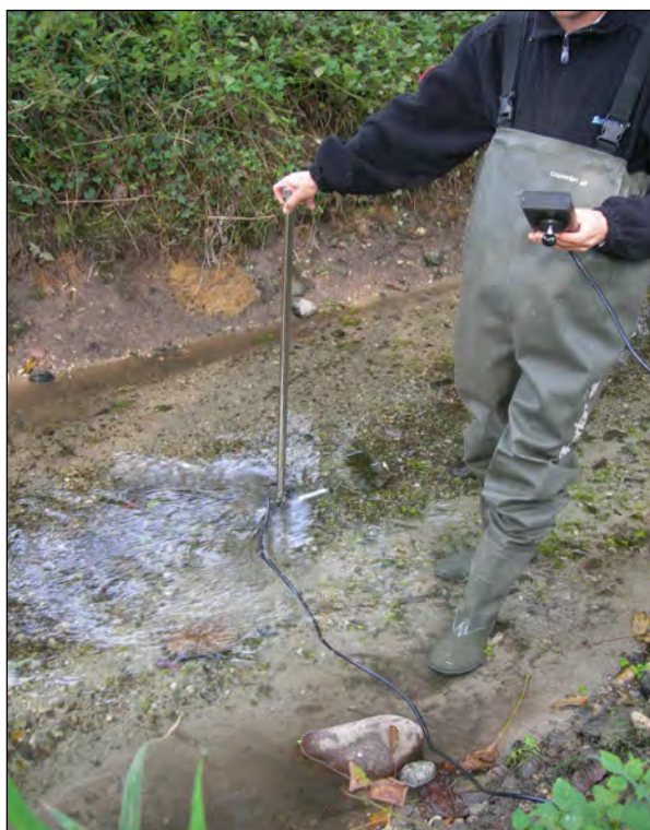
Fig. 10 – Misura della portata lungo l'asta d una risorgiva
