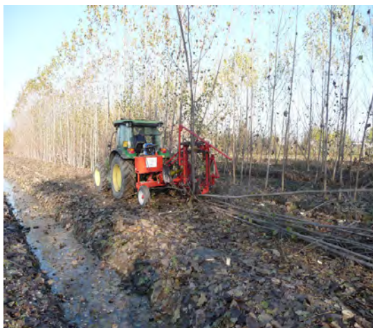
Fig. 29 - Cippatrice retroportata in azione presso un'AFI biennale (fonte: archivio Veneto Agricoltura )
