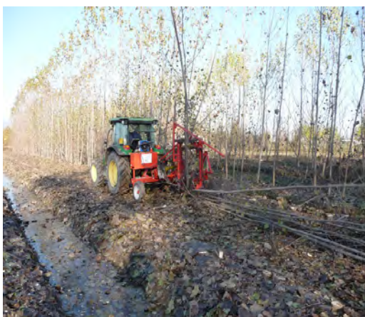
Fig. 26 - Abbattitrice-andanatrice Spapperi per impianti di AFI biennali (fonte: archivio Veneto Agricoltura )
