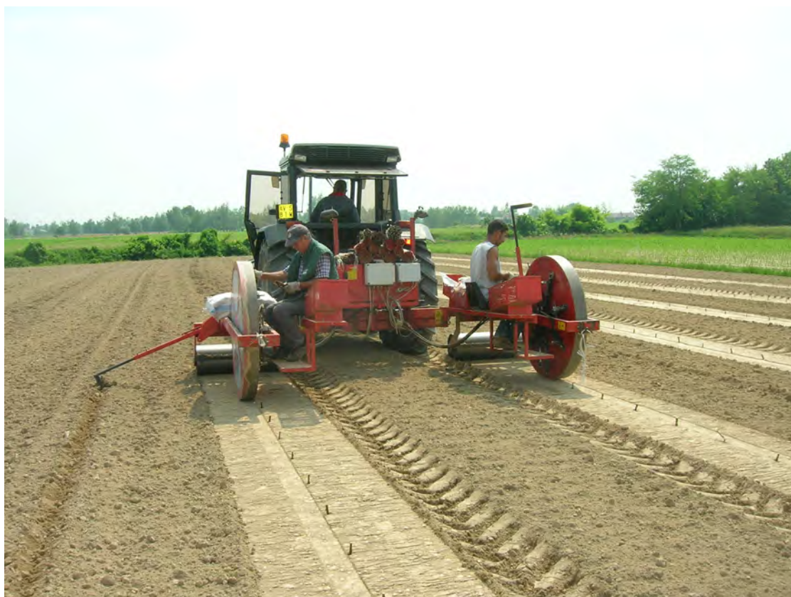
Fig. 22 - Messa a dimora di talee con trapiantatrice (fonte: archivio Veneto Agricoltura )
