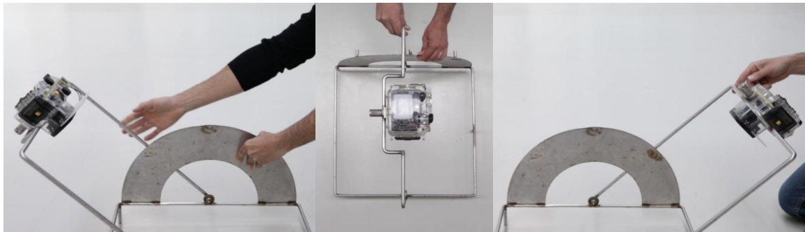
Figura 2-1. Alloggiamento per fotocamera digitale utilizzato per l'analisi fotografica della comunità bentonica di substrato rigido. Sono illustrate le 3 angolazioni alle quali può lavorare. Figure 2-1. Stainless steel bracket used for the homing of the HD digital camera. Pictures of the 3 angles of shooting are reported.
