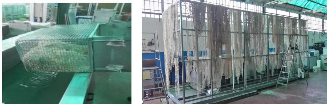
Figura 6-9 Fase di sgocciolatura e auto-asciugatura delle reti.
