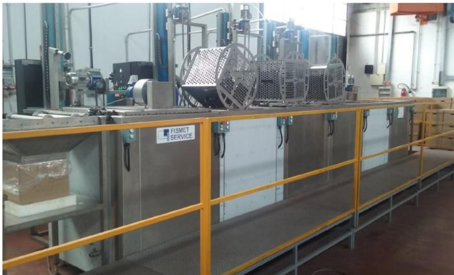
Figura 6-8 Impianto di lavaggio ad ultrasuoni. Fonte: Fismet Service S.r.l.
