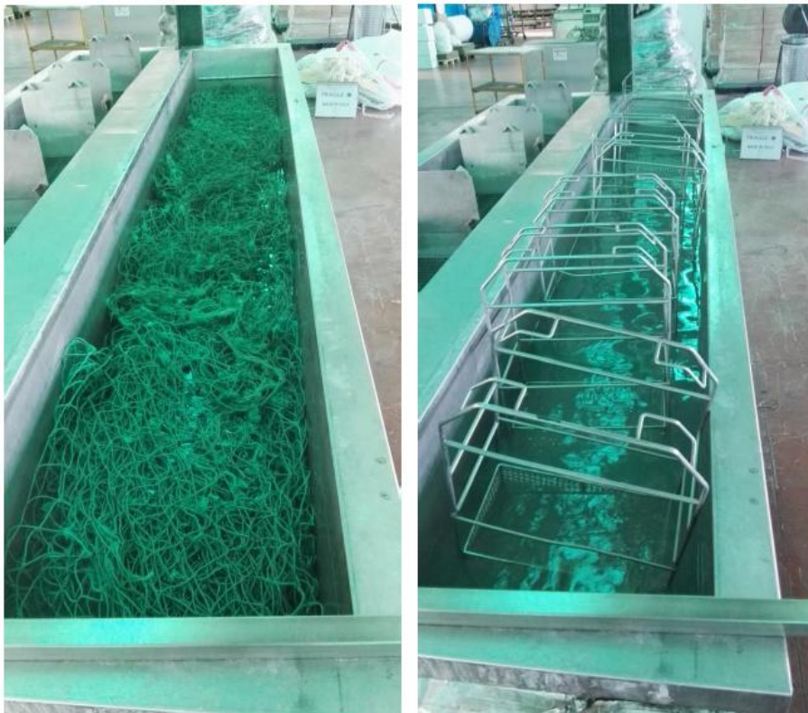
Figura 6-7 Reti in ammollo. Fonte: Fismet Service S.r.l.
