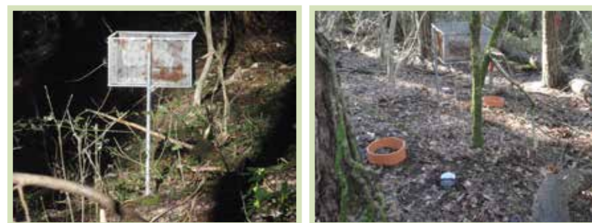
Figura 8. Trappole per la raccolta di lettiera vicino ai collari per la misura delle emissioni di gas ad effetto serra
