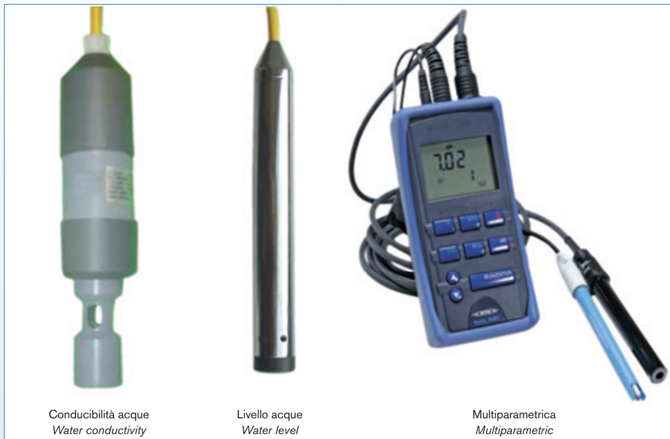
Foto 3. Strumenti utilizzati per la misura del livello e della conducibilità delle acque.
