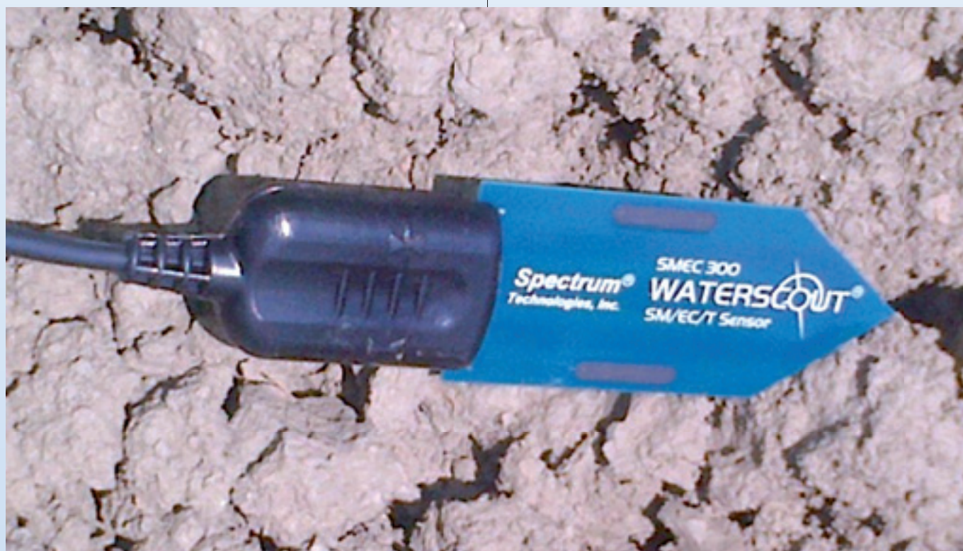
Foto 4. Sensore per la misura dell'umidità del suolo e della conducibilità delle acque interstiziali.
