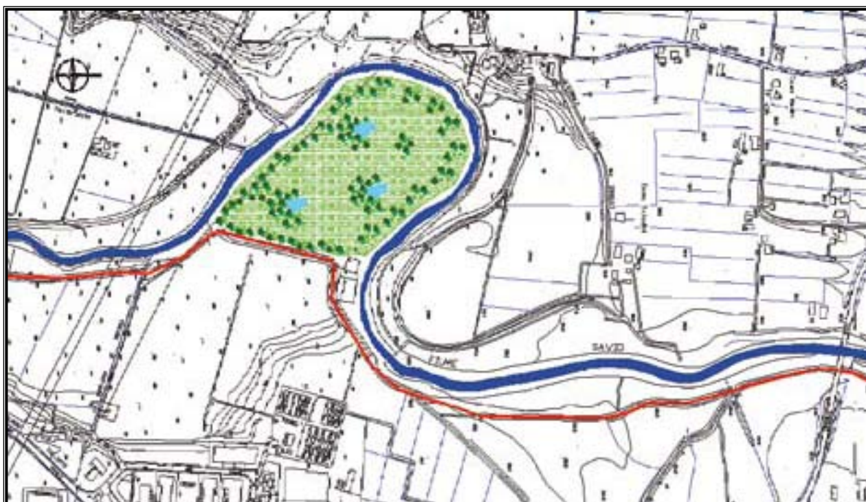
Figura 33 - Il fiume Savio e l'area di S. Anna in Comune di Cesena. L'argine che lambiva l'alveo all'interno dell'ansa è stato eliminato e ora il fiume può espandersi sino all'argine maestro (in rosso) RIVISTA CIRF n.1 2009
