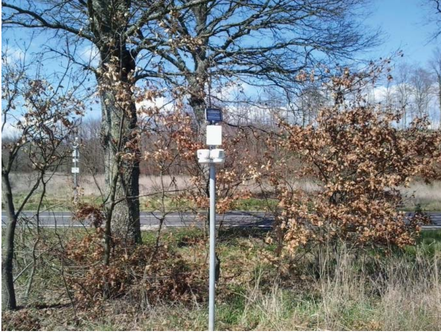
Figura 33 Sensore a infrarosso per rilevare la presenza degli animali (Foto progetto LIFE Strade)
