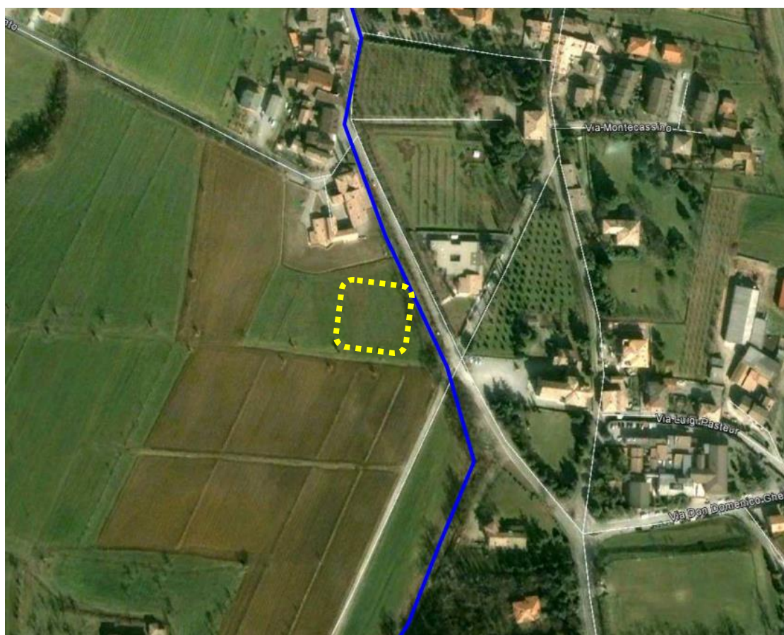
Figura 45 – Laminazione delle piene in un'area adibita all'accumulo delle acque, "acquisita" mediante servitù idraulica
