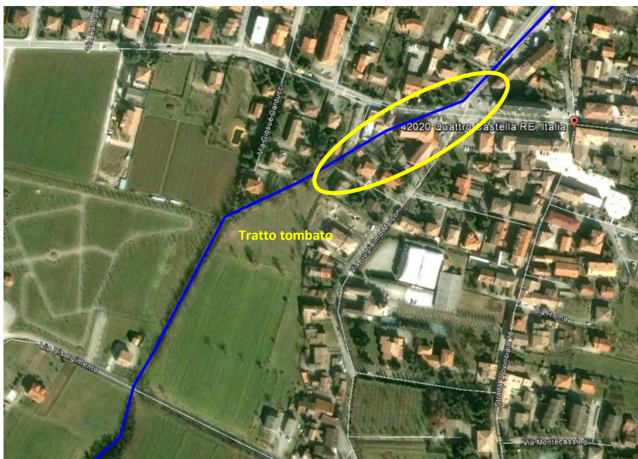
Figura 47 – Punto critico 1 del Rio Monticelli – Tratto tombato.
