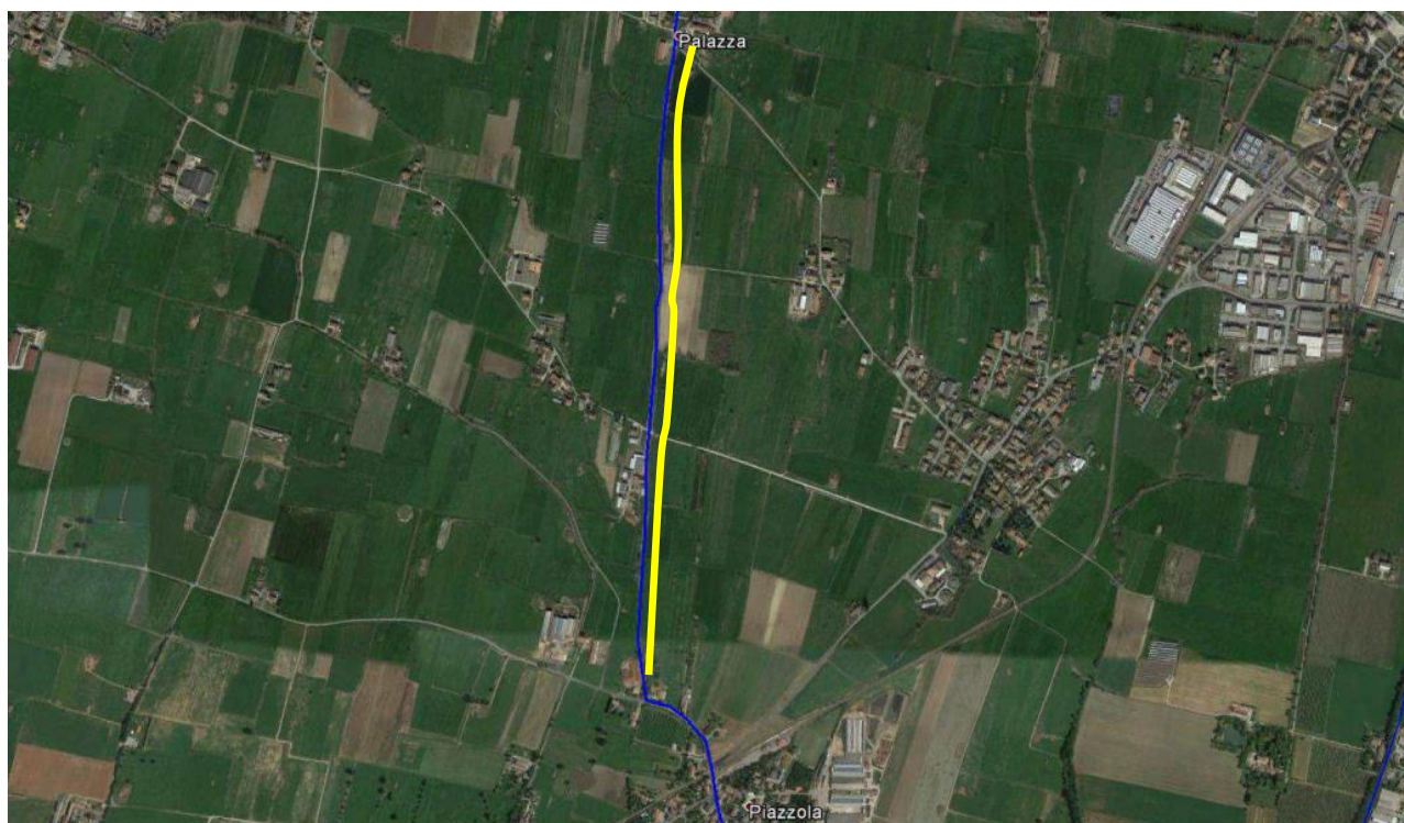
Figura 96 – Forestazione e allargamento di sezione del rio (linea gialla)
