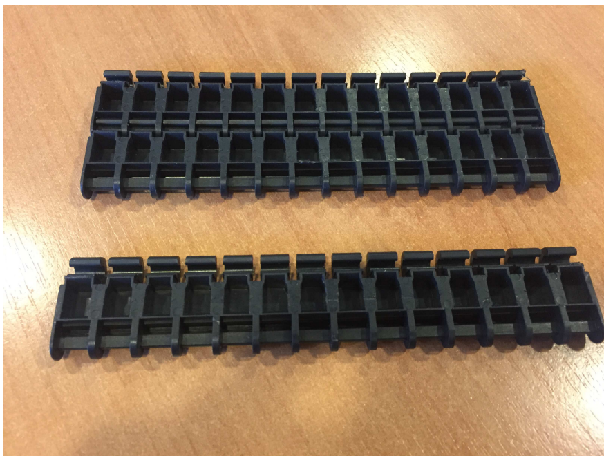
Fig.2 Listello prototipo nastro in polipropilene riciclato parte inferiore
