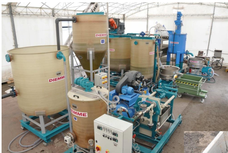
Figura 7: Vista del prototipo realizzato per di testare diversi cicli di trattamento "soil-washing" sui sedimenti campionati dal Porto di Ravenna (sopra).
