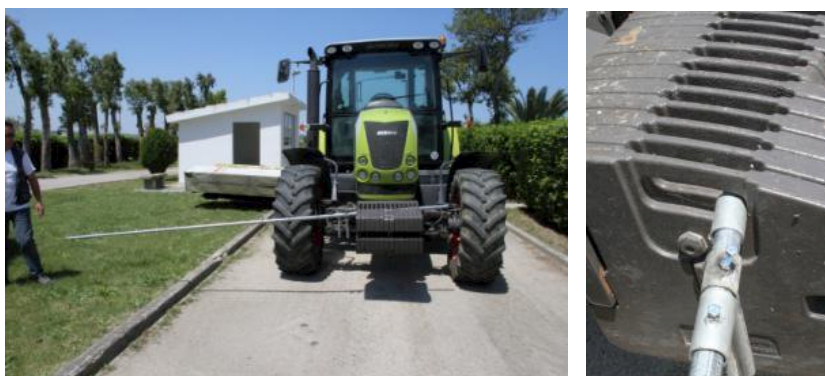
Barra di involo montata su trattore dell'azienda Di Vaira. A destra dettaglio dell'aggancio della barra
