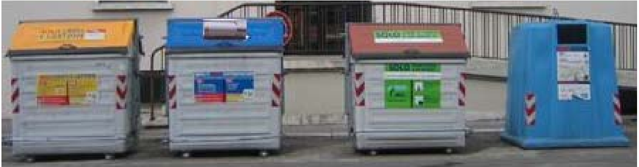
Figura 2: modello di "multi postazione" a cassonetti stazionari con l'inserimento del sistema a controllo volumetrico a calotte sul RU indifferenziato.
